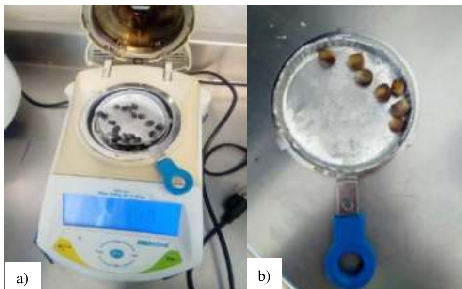
Figura 15. a) Termo balanza con la muestra húmeda, b) Charola con la muestra en seco.
