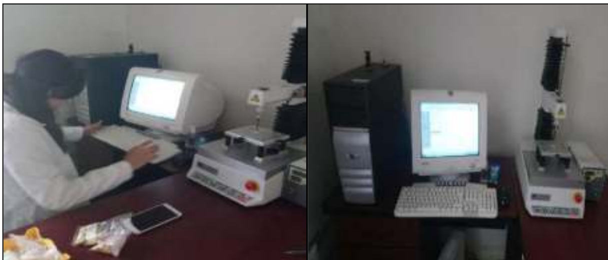
Figura 10. Análisis de textura del grano, en 10 muestras por genotipo, con sus tres densidades de población.
