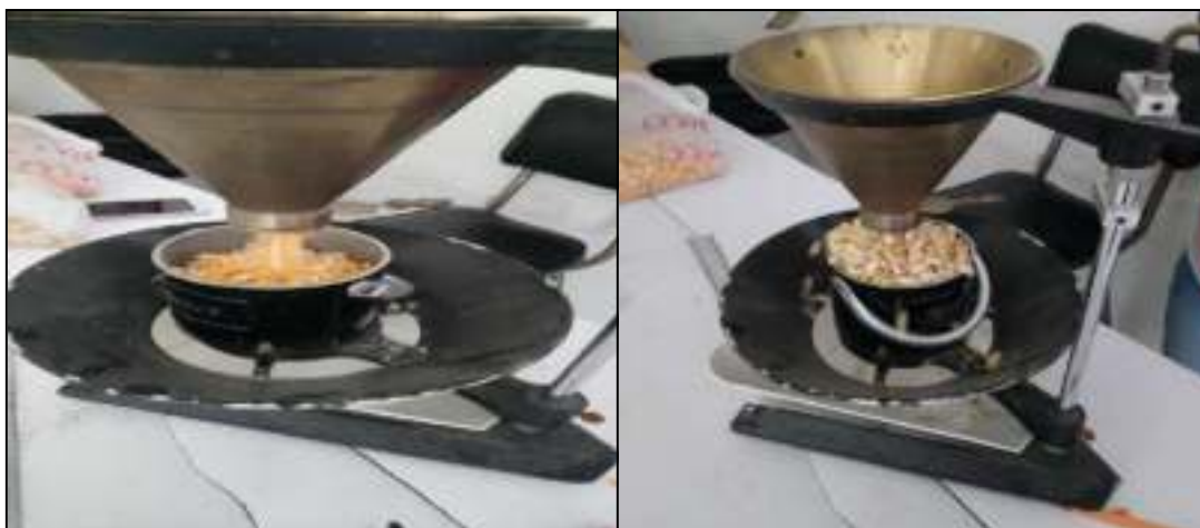
Figura 13. Peso del grano de maíz utilizando la balanza de peso volumétrico o cono.
