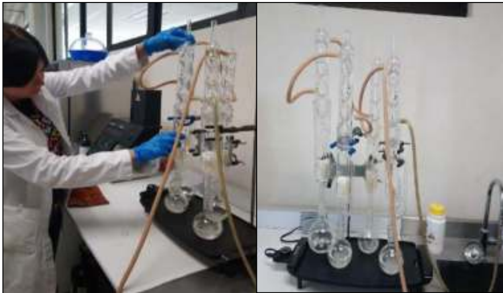
Figura 15. Equipo Soxhlet utilizado en la proporción de aceite en los seis genotipos de maíz.
