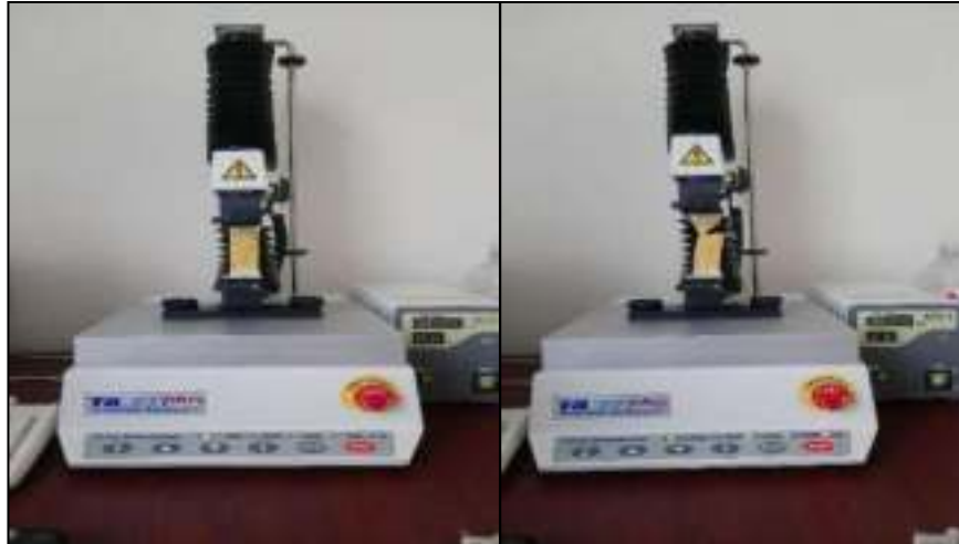
Figura 28. Muestra de tortilla colocada en el texturometro para análisis de resistencia y elongación.
