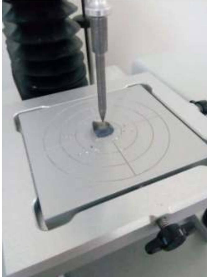
Figura 12. Análisis de textura en equipo Texturometro manual TA-XT2i.
