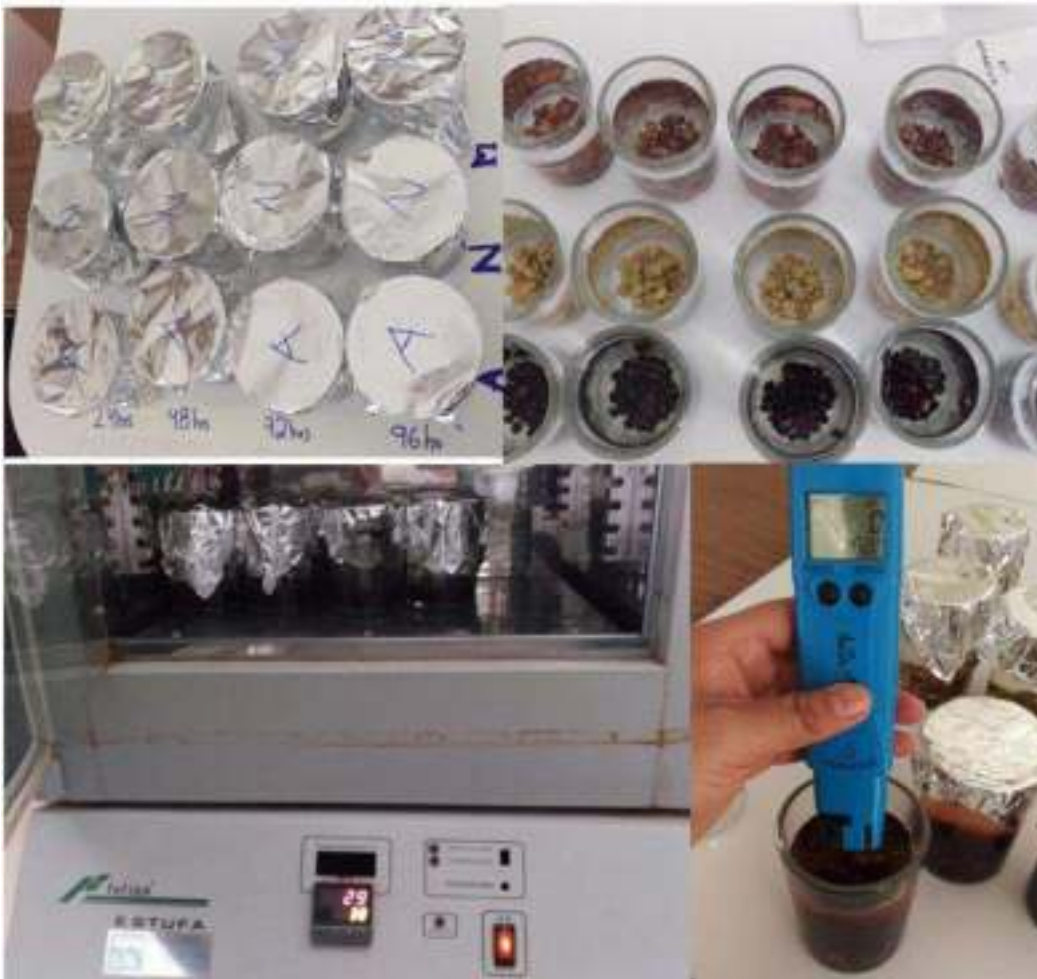
Figura 4.5. Prueba de conductividad eléctrica.
