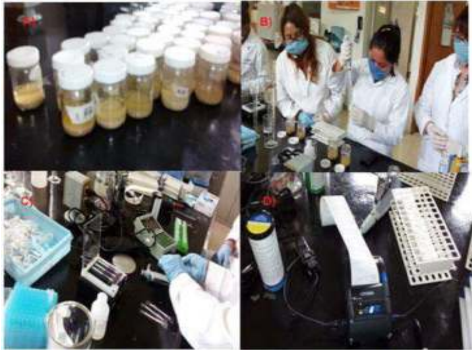
Figura 4.8.2.1.1. A) Muestras molidas con metanol al 70 %. B) Dilución y filtrado de muestras. C) Incubación de tiras. D) Impresión de la cantidad de aflatoxinas en ppb.
