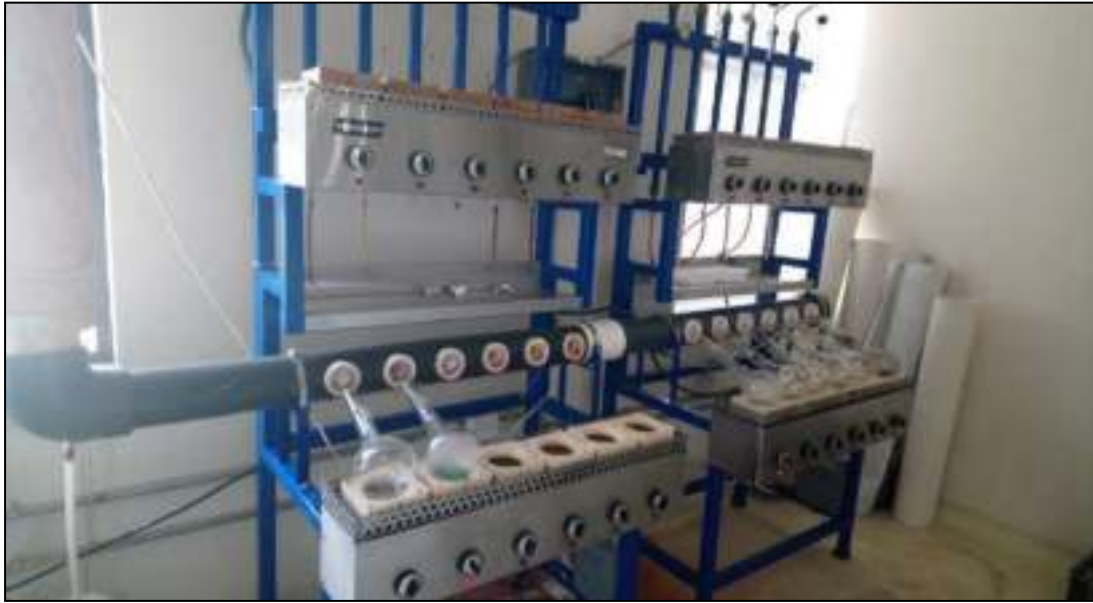
Figura 16. Determinación de proteína en grano de maíz con el equipo Kjeldahl–Gunning.
