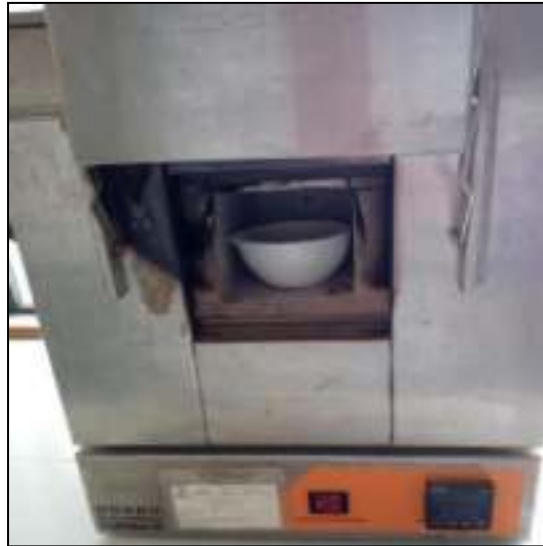
Figura 18. Equipo mufla y crisol con muestra en su interior.
