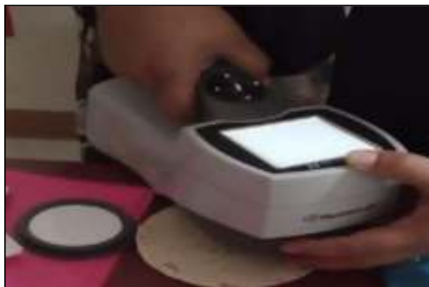
Figura 29. Toma de colorimetría en tortilla para detectar la luminosidad.
