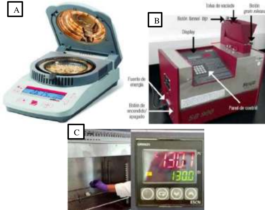
Figura 5. A: Termobalanza; B: Equipo Steinlite; C: Estufa de secado
